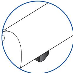
Tlumič je integrován přímo ve vodící tyči
