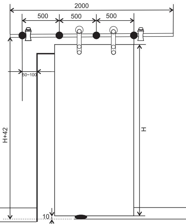
Designové kování pro skleněné posuvné interiérové dveře o maximální hmotnosti 90 kg.
